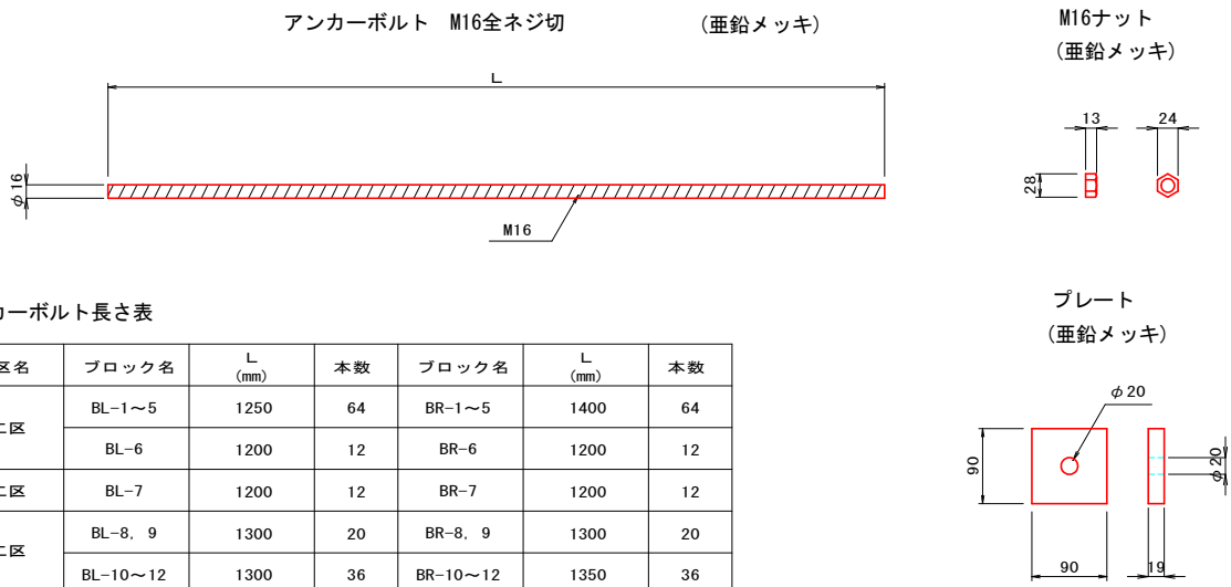
側壁アンカーボルト詳細図
